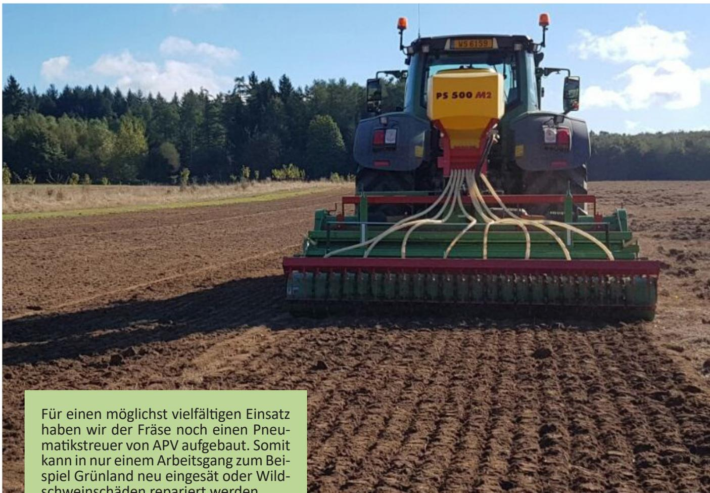
Für einen möglichst vielfältigen Einsatz haben wir der Fräse noch einen Pneumatikstreuer von APV aufgebaut. Somit kann in nur einem Arbeitsgang zum Beispiel Grünland neu eingesät oder Wildschweinschäden repariert werden.
