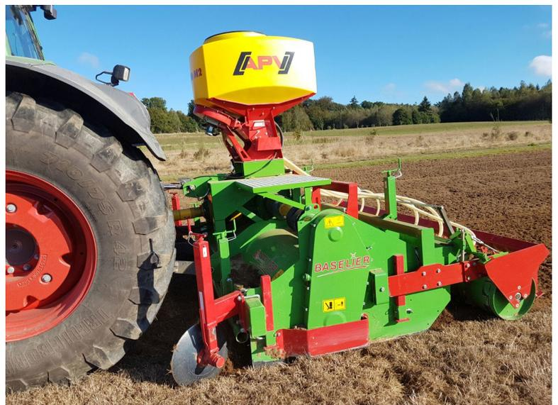
Seitenansicht der Umkehrfräse mit aufgebauter Saatschiene
