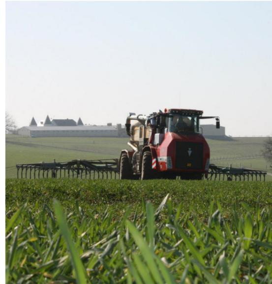
*Durch die großvolumige Bereifung und das spurversetzte Fahren im „Hundegang“ arbeitet die Maschine trotz seiner Größe besonders bodenschonend.*
