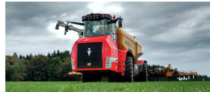
*Durch die großvolumige Bereifung und das spurversetzte Fahren im „Hundegang“ arbeitet die Maschine trotz seiner Größe besonders bodenschonend.*
