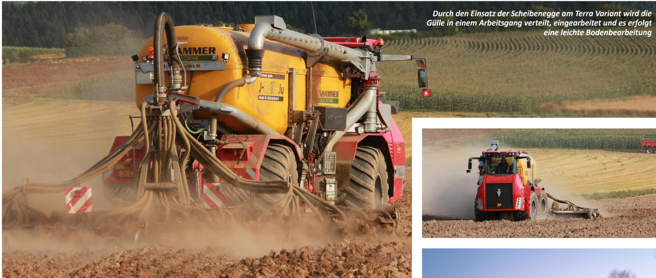
*Durch den Einsatz der Scheibenegge am Terra Variant wird die Gülle in einem Arbeitsgang verteilt, eingearbeitet und es erfolgt eine leichte Bodenbearbeitung*
