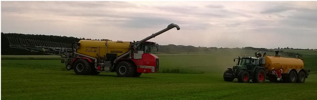
*Bei sehr großen Flächen kann der Einsatz der Ausbringfässer als Güllezubringer interessant sein – dadurch kann die Gülle direkt auf dem Feld übergeben werden. Die unproduktiven Zeiten des Selbstfahrers werden reduziert und die Schlagkraft wird weiter erhöht.*
