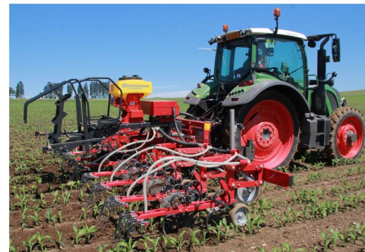
*Die Kamerasteuerung ermöglicht eine höhere Geschwindigkeit und damit auch eine höhere Kapazität.*
