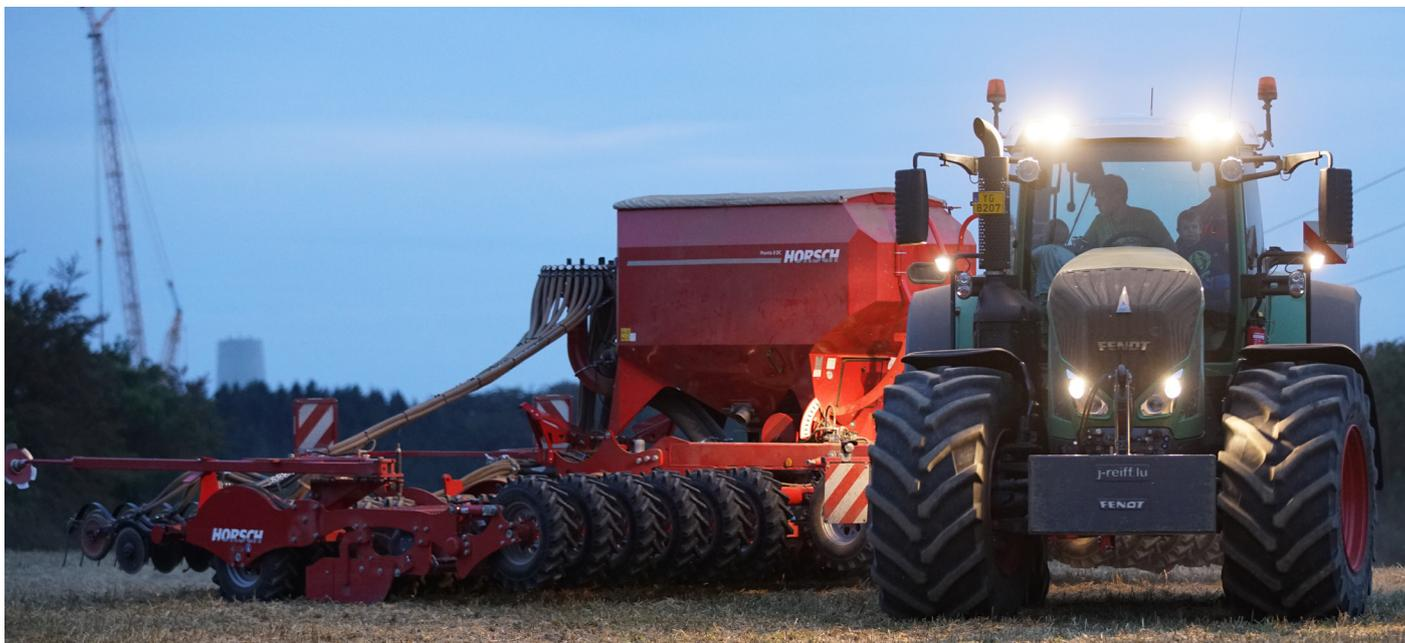
Seit dem Frühjahr 2016 setzen wir auf unserem Betrieb eine neue Sämaschine der Firma Horsch ein. Die Anforderungen an die Maschine waren: 8 Meter Arbeitsbreite, exakte Saatgutablage und hohe Fahrgeschwindigkeiten sowohl bei Drillsaat nach Pflug also auch bei Mulch- oder Direktsaat.
