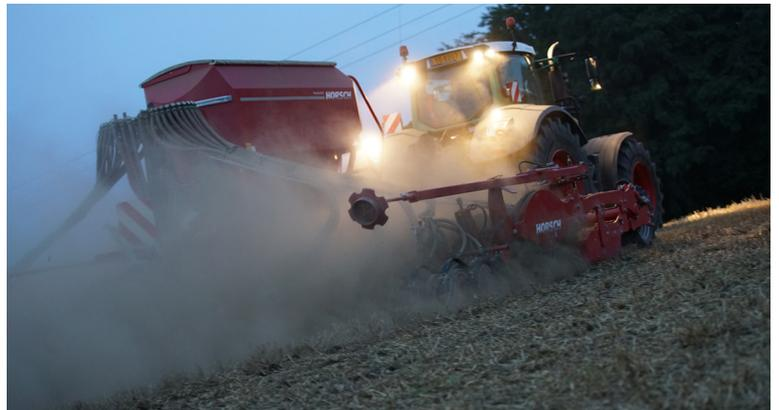
**Die TurboDisc Säscharre mit integrierter Druckrolle ermöglichen eine präzise Tiefenführung auch bei hohen Geschwindigkeiten. Der Exaktstriegele bedeckt die Saatzeilen gleichmäßig mit Erde.**
