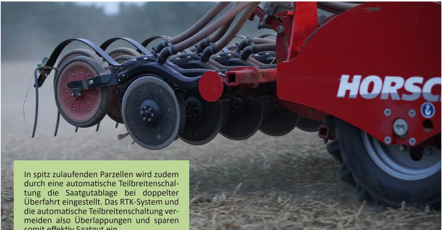
In spitz zulaufenden Parzellen wird zudem durch eine automatische Teilbreitenschaltung die Saatgutablage bei doppelter Überfahrt eingestellt. Das RTK-System und die automatische Teilbreitenschaltung vermeiden also Überlappungen und sparen somit effektiv Saatgut ein.
