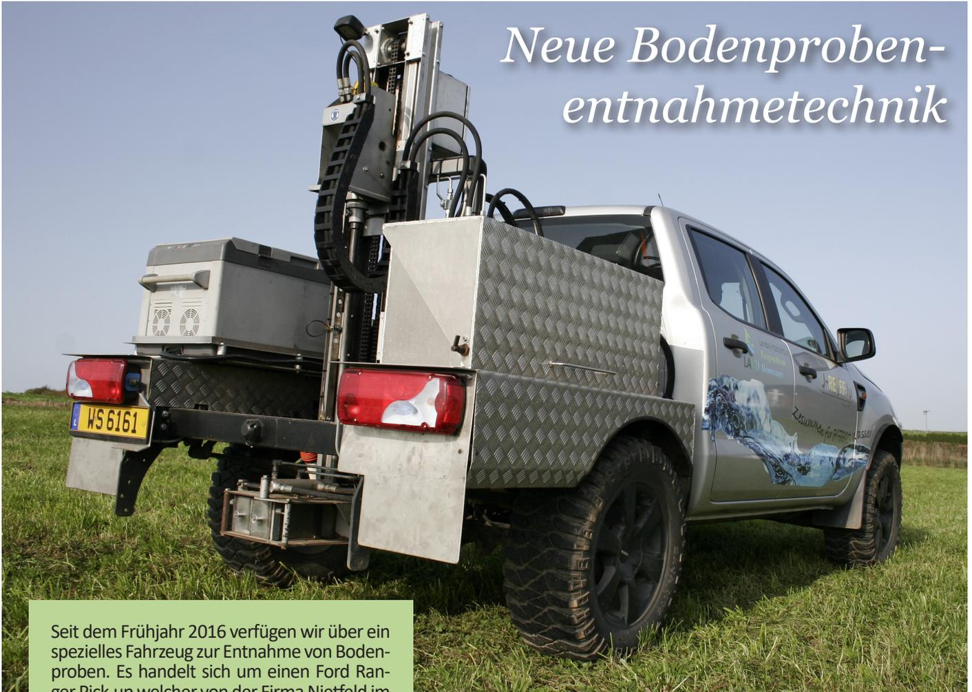
Seit dem Frühjahr 2016 verfügen wir über ein spezielles Fahrzeug zur Entnahme von Bodenproben. Es handelt sich um einen Ford Ranger Pick-up welcher von der Firma Nietfeld im niedersächsischen Quakenbrück speziell zur Bodenbeprobung umgebaut wurde.
