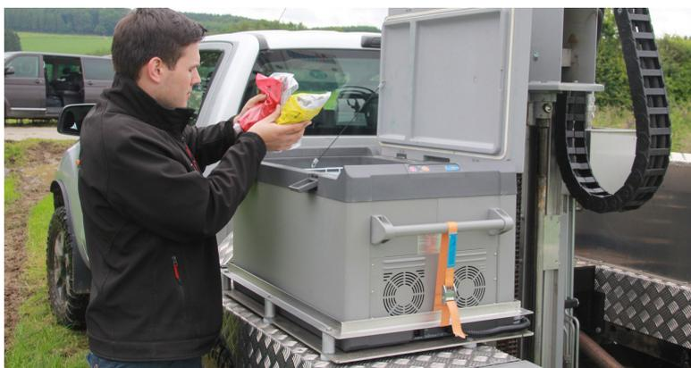
**Um Veränderungen der Probe zu vermeiden wird die Bodenprobe gleich nach der Entnahme runtergekühlt.**
